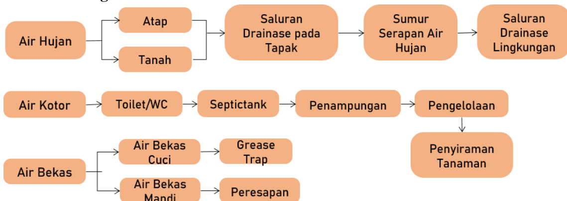
Gambar.18 Sistem Jaringan Air Kotor dan Air Bekas Pakai
