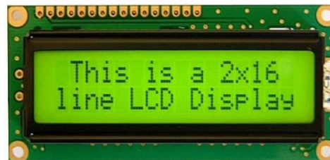
Gbr. 9 Modul LCD M1632 (Sumber :Faizal Zulmi, 2013)
