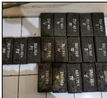
Gambar 1 Hasil pembuatan benda uji paving block plastik polypropylene
