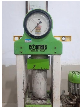
Gambar 1 Pengujian Kuat Tekan Beton
