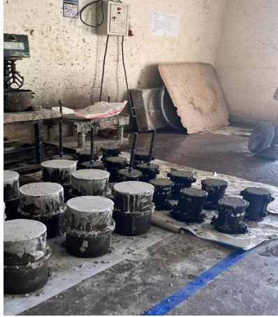
Gambar 4. Pembuatan Benda Uji Sampel Beton SCC Mutu K 350
