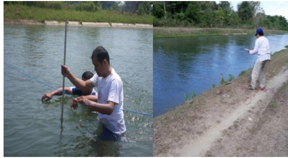
Gambar 12. Pengukuran di Saluran Induk, Current meter & Pelampung
