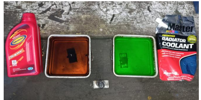
Gambar 1. Spesimen Dengan Pendinginan Oli Mesran SAE 20W-50 dan Coolant Master Radiator.
