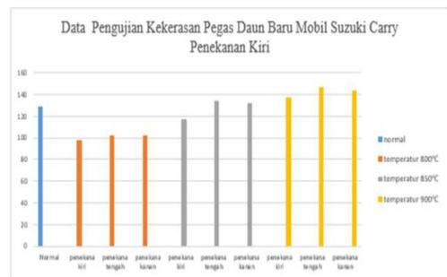
Gambar 4.1 Grafik Hasil Pengujian Kekerasan Brinell
