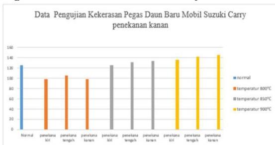
Gambar 4.3 Grafik Hasil Pengujian Kekerasan Brinell
