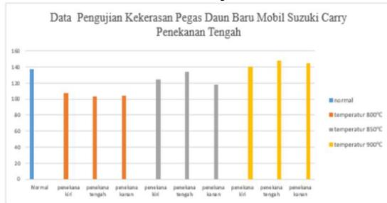
Gambar 4.2 Grafik Hasil Pengujian Kekerasan Brinell
