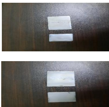
Gambar 4. Spesimen uji metalografi dan uji kekerasan vickers baja ST 37 dan baja ST 42.
