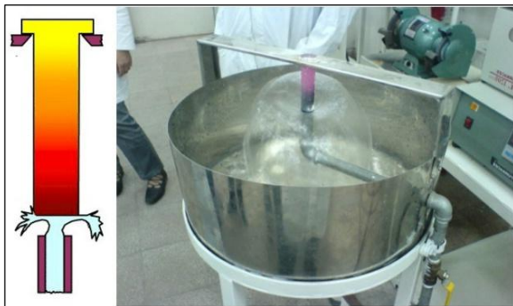
Gambar 3. Alat Jominy Test (Yadi dkk., 2017)
