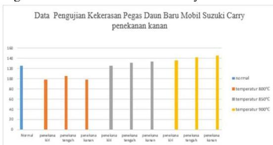
Gambar 4.3 Grafik Hasil Pengujian Kekerasan Brinell
