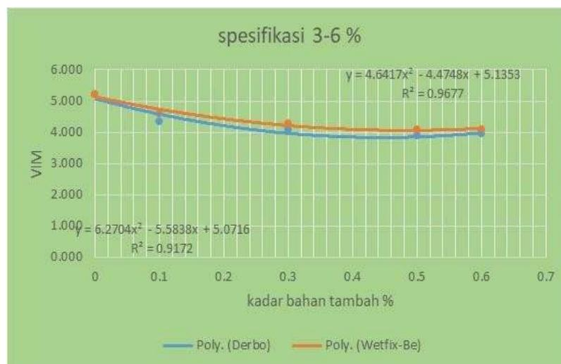
**Gambar 7** Hubungan antara Kadar Zat Aditif Derbo dan Wetfix terhadap Void In Mixture (VIM)
