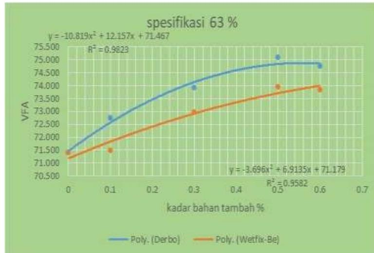
Gambar 9 Hubungan antara Kadar Zat Aditif Derbo dan Wetfix terhadap VFA
