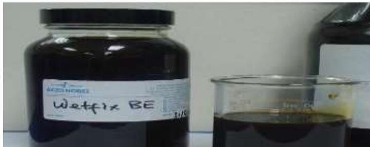
Gambar 2 Zat aditif anti stripping agent (Wetfix)
