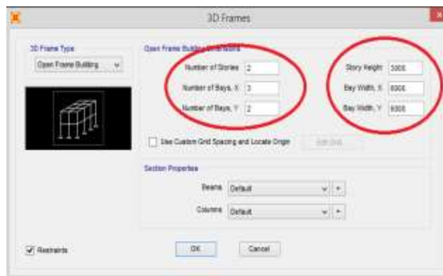
Gambar 2 Mengatur grid struktur
