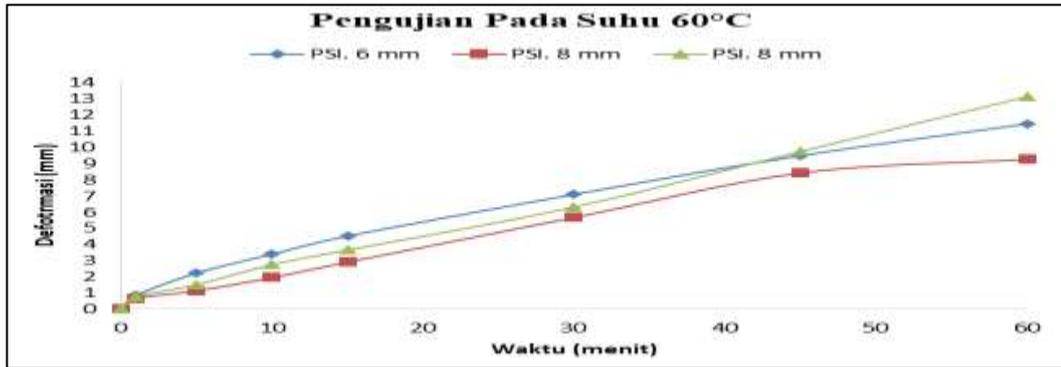
**Gambar 3** Grafik hubungan antara waktu dan deformasi pada suhu 60°C
