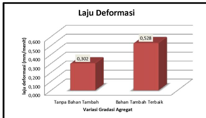
**Gambar 9** Grafik hubungan serat serabut kelapa terhadap laju deformasi menggunakan variasi serat serabut kelapa
