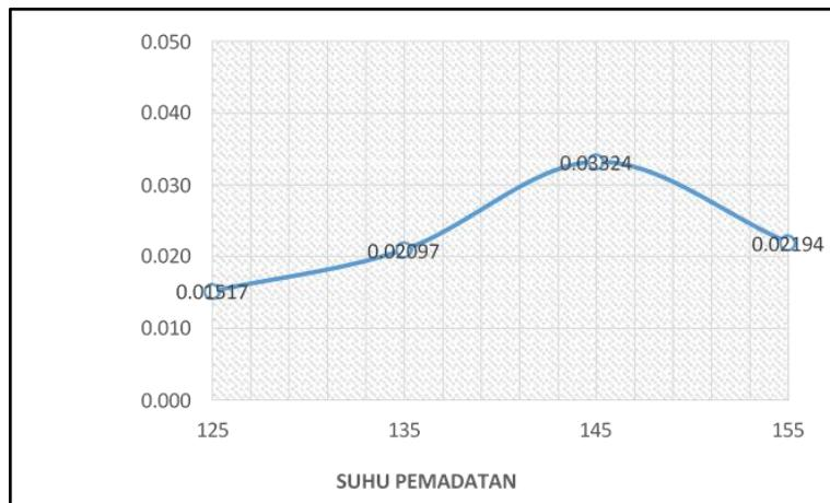
Gambar 3 Grafik hubungan regangan terhadap variasi suhu pemanasan
